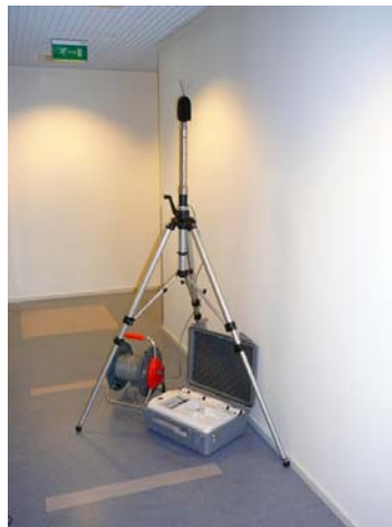
Kuva 1. Lochard Emu2200 melumittari ja ulkomikrofoni jalustallaan
